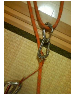
タイブロック、プーリー付きカラビナをセットした例 (プーリーを持っている場合はなお良い)
