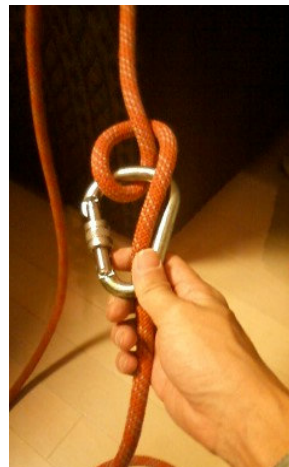
④ムンターヒッチが完了
